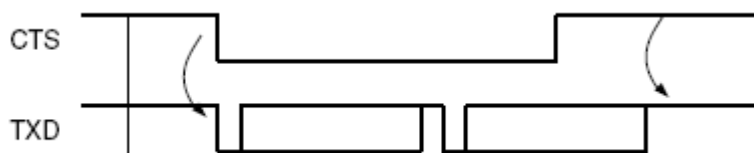
图 31-18 当用硬件握手操作时发送器的动作
